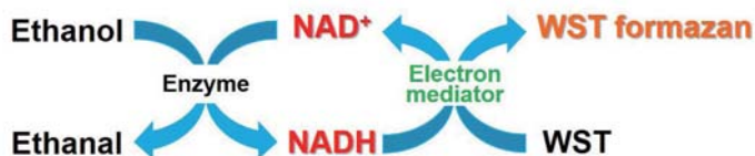
图1. NAD/NADH试剂盒测定NAD的原理
