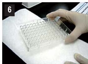
6 倒掉溶液并用洗涤缓冲液洗涤各孔。将板放在纸巾上轻拍几次以尽可能干净地去除缓冲液。
