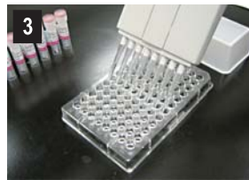
3 将ARP-DNA标准溶液或ARP标记的样品DNA溶液加到各孔中。加入DNA结合溶液，并将培养板置于室温下过夜。
