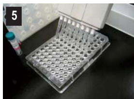
5 将HRP-链霉亲和素溶液加到每孔中并置于37 °C下培养1 h。
